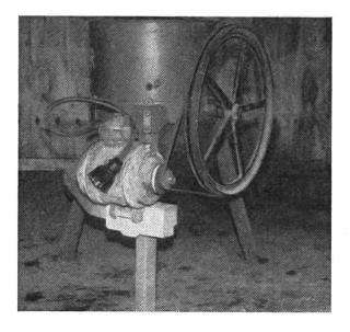
den sich fragen, warum ich auf dem Rübenbröckler einen Aufbaumotor verwende. Nachdem der Bröckler auf unserem Betrieb jährlich mindestens 150mal verwendet wird, erleichtert der Aufbaumotor dem vielbeschäftigten Melker das Arbeiten wesentlich. Da die Maschine immer an der gleichen Stelle verwendet wird, habe ich eine unfallsichere Stromzufuhr (Leitung) anbringen lassen. Wie das Bild zeigt, ist das Kabel nur 1 m lang.
