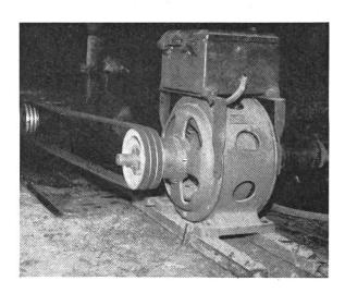
giessen, ohne ein Rutschen zu bemerken. Die Güllenpumpe ist ebenfalls mit einer Keilriemenscheibe von 150 mm ausgerüstet. Die Tourenzahl wird demnach nicht verändert und beträgt im vorliegenden Fall ca. 1400 U/min. Beim Aufstellen des Motors ist selbstverständlich darauf zu achten, dass die Riemen gradlinig verlaufen, da sonst der Verschleiss zu gross wäre. Die abgebildeten Keilriemen sehen sozusagen noch wie neu aus, obwohl sie schon 3 Jahre in Betrieb sind.
