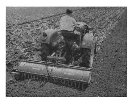
Abb. 7: Saatbettzubereitung mit zapfwellengetriebener Spatenegge
