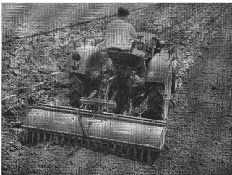
Abb. 7: Saatbettzubereitung mit zapfwellengetriebener Spatenegge
