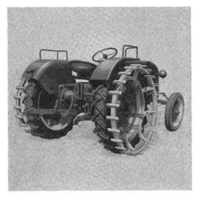
Abb. 15: Segment-Gitterräder für Bereifung 8-32''
