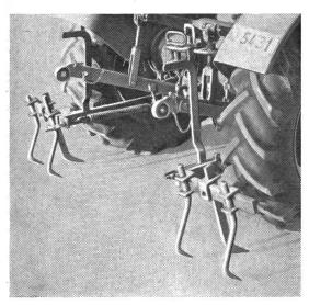
Abb. 14: Spurlockerer mit Befestigung unter der Radachse
