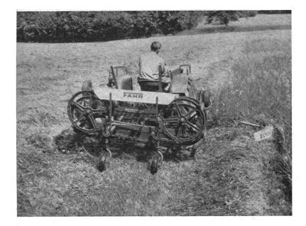
Abb. 13: Mähen und Zeiten im gleichen Arbeitsgang
