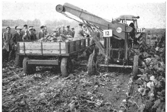
Abb. 2a u. 2b: Die gereinigten Rüben werden auf einen nebenher fahrenden, hydraulisch kippbaren Anhänger gefördert. Jeder Maschine sind zwei Fahrzeuge zugeteilt, also insgesamt 3 Traktoren! Das Rübenkraut bleibt am Boden liegen und wird nicht verwertet.
