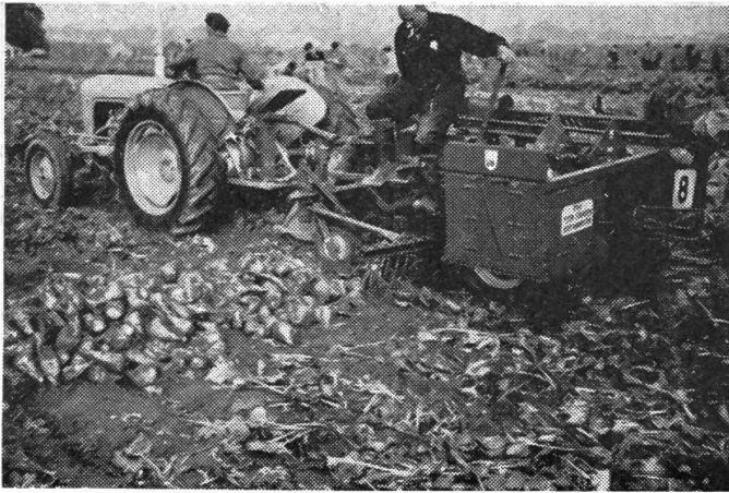
Abb. 3: Eine englische Vollerntemaschine mit Querablage der Rüben, das Kraut wird ebenfalls nicht verwertet.
