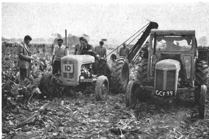
Abb. 2a u. 2b: Die gereinigten Rüben werden auf einen nebenher fahrenden, hydraulisch kippbaren Anhänger gefördert. Jeder Maschine sind zwei Fahrzeuge zugeteilt, also insgesamt 3 Traktoren! Das Rübenkraut bleibt am Boden liegen und wird nicht verwertet.
