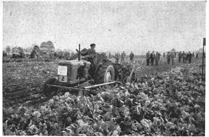
Abb. 3: Eine englische Vollerntemaschine mit Querablage der Rüben, das Kraut wird ebenfalls nicht verwertet.
