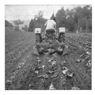
Abb. 2: Dreireihiges Graben mit dem Schüttelsiebgraber
