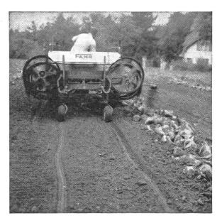
Abb. 4: Erstellen von Rübenschwaden mit der Kettenrechen-Heuerntemaschine
