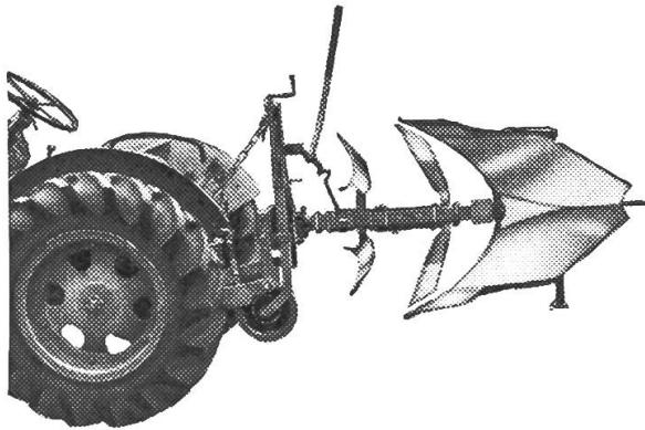
**ALTHAUS** verwandelt Ihren Selbsthalterpflug in einen ausgezeichneten **Einmannpflug mit eingebauter Bruchsicherung.**
