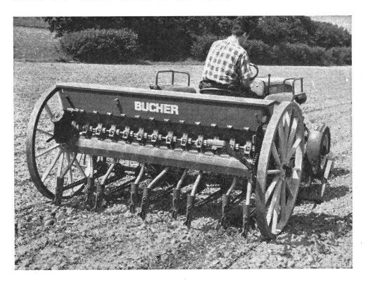
Versuche mit der Bucher-Sämaschine zeigten, dass jede in Betracht kommende Menge Harnstoff «Ems» (von 15—420 kg pro Hektare) sehr exakt eingestellt und ausgestreut werden kann.
