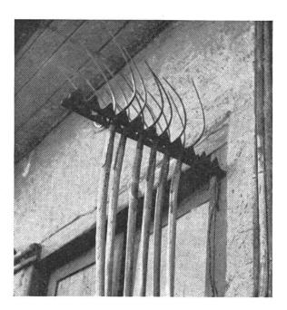
Aus alten Mähmaschinenmessern, die an einem Balken eingeschlagen werden, kann man sich einen praktischen Gerätehalter machen.
