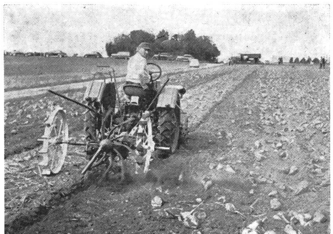
Abb. 1: So arbeitet das Rübenrodegerät «Au» am Gespannroder hinter dem Traktor. (Selbsttätige Steuerung)
