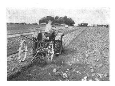
Abb. 1: So arbeitet das Rübenrodegerät «Au» am Gespannroder hinter dem Traktor. (Selbsttätige Steuerung)
