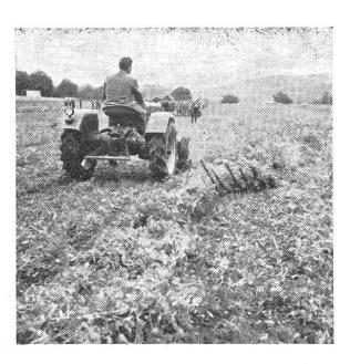
Abb. 9: Weglegevorrichtung in Form von Stahlstäben
