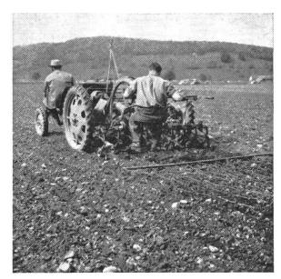
Abb. 5: Hackgerät nach Pendelhackensystem (Anstellwinkel zum Stiel 45°)
