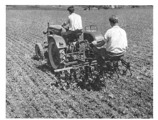
Abb. 3: Vielzwecktraktor und lenkbares Anbau-Vielfachgerät im Einsatz
