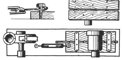
folgen. Falls die am Aufstellungsort verbleibende Schraube stört, kann auch ein Loch in den (Tenn-)Boden gebort werden und im Bedarfsfalle ein Metallbolzen hineingesteckt werden. Die Abbildung zeigt unten die Gesamtanordnung von oben (rechts den Motor, links eine Jauchepumpe, in der Mitte das Spannschloss), rechts oben den Blick auf die Unterseite der beiden Unterlagsbohlen mit Führungsschlitz, links oben eine der beiden Holzschrauben mit einem Ende des Spannschlosses.
