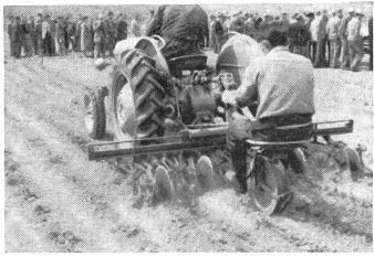
Abb. 8a: Stützradgelenktes Anbau-Vielfachgerät (2 Stützräder), ausgerüstet auf der linken Seite mit Bügelzughacken (ohne Pendelgelenk) rechts mit Gänsefüssen und Pflanzenschutzscheiben. (Photo H. Meyer)
