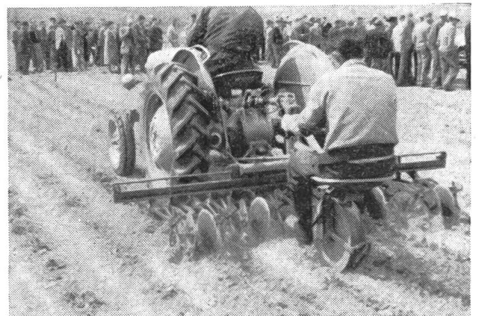
Abb. 8a: Stützradgelenktes Anbau-Vielfachgerät (2 Stützräder), ausgerüstet auf der linken Seite mit Bügelzughacken (ohne Pendelgelenk) rechts mit Gänsefüssen und Pflanzenschutzscheiben. (Photo H. Meyer)
