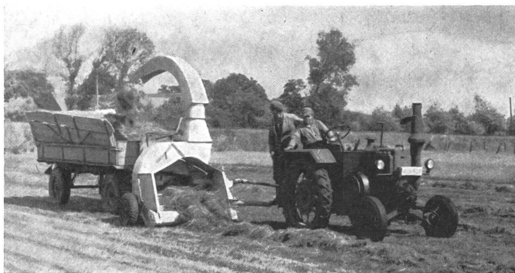
HOCO-Patent-Feldhäcksler «Rekord» beim Laden von angewelktem Gras zur Silage aus dem Schwad.
