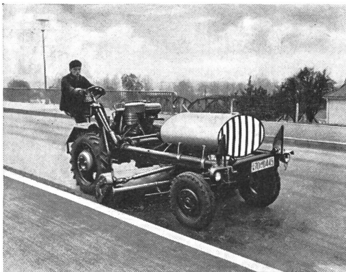
Abb. 1: Alldog mit Kehrbesen und Spritzfass
