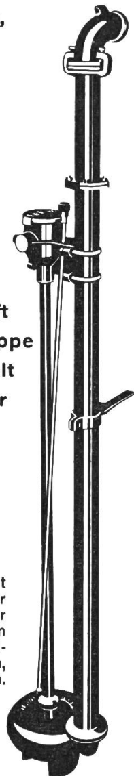
Neues Modell AEBI N52 zum Fassfüllen und Verschlauchen, mit grossen, verstopfungsfreiem Gehäuse und verbesserter Lagerung. Die Pumpenwelle ist gehärtet und geschliffen, also weitgehend gegen Abnutzung geschützt.
