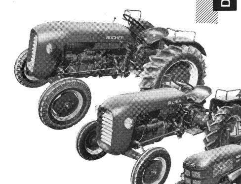
mit luft- oder wassergekühlten Motoren. Darunter die Modelle mit Contraschlupf, unabhängiger Hydraulik, fahrabhängiger und kupplungs-unabhängiger Zapfwelle, 2 Messergeschwindigkeiten sowie Doppelkupplung und Doppelsteuergerät.
