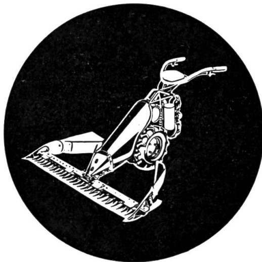
AGRIA-Spezialmotormäher, Type 1300, 5 oder 6 PS. Balken 105—160 cm mit Rückwärts- oder Zweiganggetriebe.
