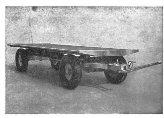
«WM»-Pneuwagen, 1,5—5 Tonnen Nutzlast, rostfreie Ganzmetallkonstruktion
