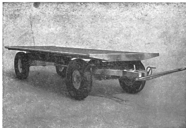
«WM»-Pneuwagen, 1,5—5 Tonnen Nutzlast, rostfreie Ganzmetallkonstruktion
