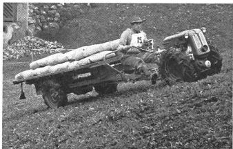
Abb. 3: Hinten auf dem Traktor mitfahrende Personen werden leicht von der ungeschützten Zapfwelle erfasst und arg verstümmelt. Die Strohpuppe muss soeben dieses Schicksal erleiden.
