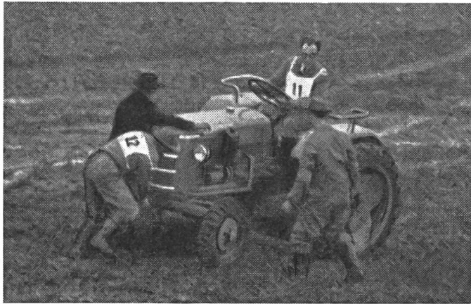
Abb. 1: Der Traktor ist im nassen Acker festgefahren. Ein «Sparen» und eine Kette genügen, um ihm ohne grosse Mühe herauszuhelfen.
