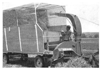
Abb. 7c und d: Spezialwagen mit Aufsätzen und Rollboden.
