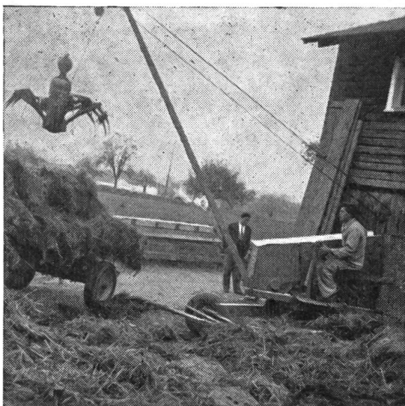
Abb. 4a und b: Fahrbarer Ladekran für Einmann-Bedienung.
