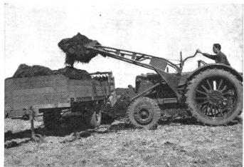
Abb. 2a und b: Der Frontlader an der Arbeit
