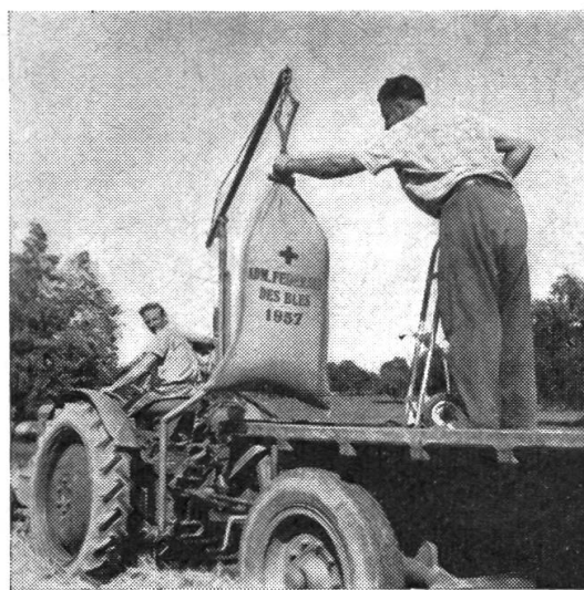
Abb. 6a und b: 6a: Abführen der Säcke von der Plattform des Mähdreschers auf bereitgestellten Wagen. 6b: Sackladen mit einfachem Hecklader an der Dreipunkthydraulik (System nach H. Marti, Othmarsingen).
