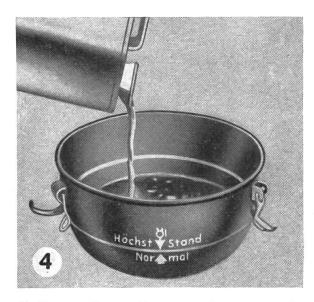
4) Motorenöl nur bis untere Normalstand-Marke einfüllen
