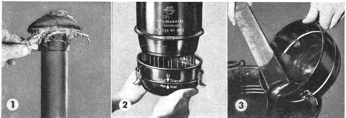
1) Ansaugrohr nachsehen 2) Oeltopf regelmässig abnehmen 3) Oelfüllung wechseln
