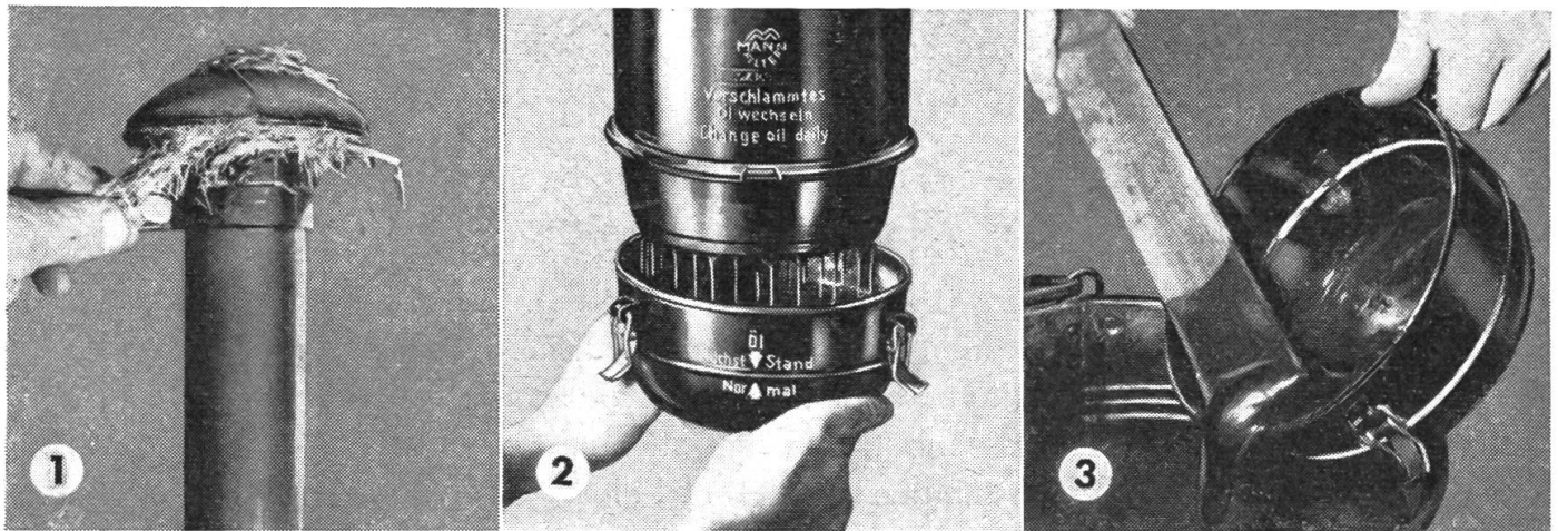
Bild d): Reihenfolge der Luftfilterreinigung
