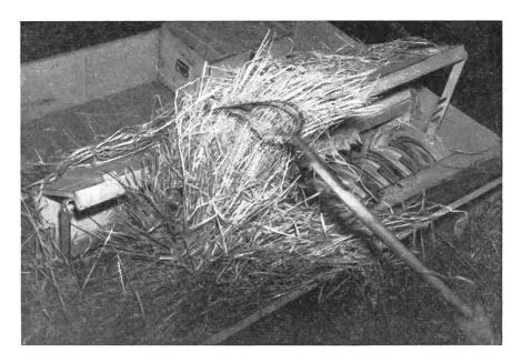
Unfallverhütend ist auch der **Selbsteinleger.** Er erhöht die Arbeitsleistung und verhindert Unfälle an der Dreschtrommel. Die Garben werden unaufgeschnitten mit der Gabel in den Selbsteinleger geworfen. Dieser zerschneidet die Garbenschnur und führt das Dreschgut gleichmässig (in kleinen Paketen) dem Tambour zu.
