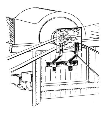
Behelfsmässige Abschirmung der Riemenscheibe bei älterer Maschine
