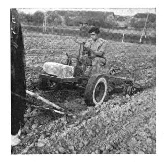
Abb. 3a: Der Geräteträger beim Nachhäufeln von Kartoffeln
