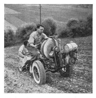
Abb. 1a: Spinne ausgerüstet mit halbautomatischem Pflanzgerät für Kartoffeln bei 40 % Steigung
