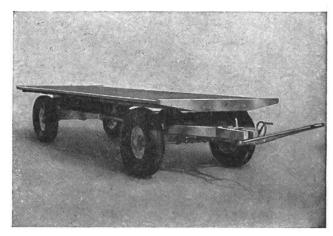
«WM»-Pneuwagen, 1,5—5 Tonnen Nutzlast, rostfreie Ganzmetallkonstruktion
