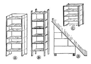
Stehen genügend Kisten zur Verfügung, legt man sie flach übereinander und verbindet sie durch Leisten, deren Verlängerung gleichzeitig die Füsse des Regals abgeben (Bild B).
