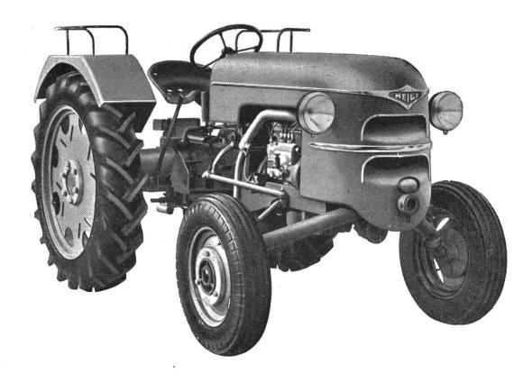
Der Meili-Allzweck-Diesel-Traktor kann mit dem wassergekühlten MERCEDES-Diesel-Motor oder dem luftgekühlten MWM-Diesel-Motor ausgerüstet werden. Verlangen Sie unsere Prospekte oder eine unverbindliche Vorführung dieses modernen, äusserst leistungsfähigen und bestbewährten Traktors.
