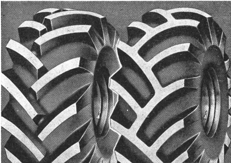
Abb. 12: Zusammenhängende und offene (open center) Profilierung von Firestone-Reifen
