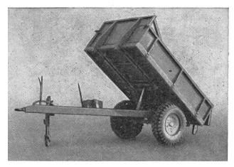
Jniversal-Anhänger als Kipper 1,5 m³ Inhalt, nit abgelegter Front- und Rückwand als Heuund Graswagen verwendbar.
