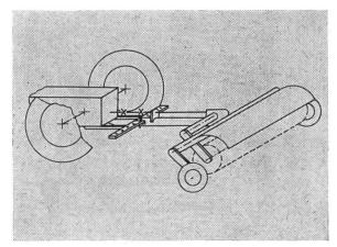
Abb. 4: An der Ackerschiene befestigte Anhängefräse
