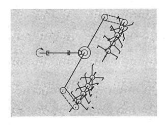
Abb. 9: Schema einer Fräse mit geteilter Fräswalze (Kirsch).
