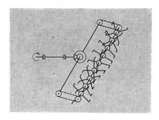
Abb. 7: Schema einer Fräse mit zweiseitigem Kettenantrieb
