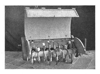
Abb. 2: Spiralige Anordnung der Fräswerkzeuge.
