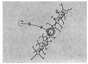
Abb. 5: Anbaufräse am Dreipunktgestänge
