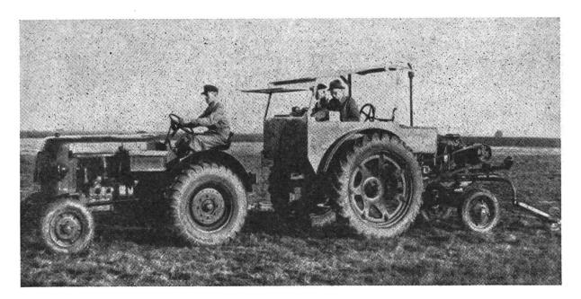
Abb. 1: Versuchseinrichtung des Institutes für Schlepperforschung zum Messen von Zugkraft und Schlupf der Traktorreifen. Links auf dem Bild der Traktor mit den zu untersuchenden Reifen, rechts der Bremswagen mit den Messinstrumenten.
