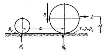
Abb. 2: Die am Schlepper angreifenden
