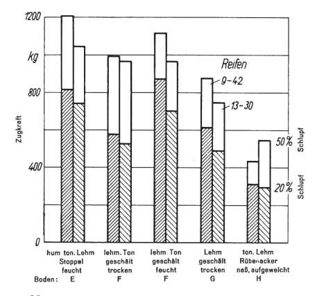
Abb. 5: Einfluss der Reifenbreite auf die Zugkraft bei 20 bzw. 50 % Schlupf.
