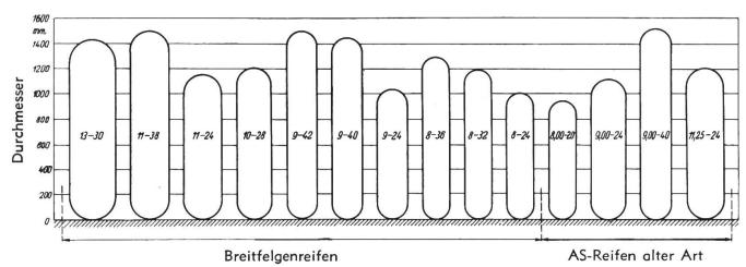
Abb. 4: Gegenüberstellung der in diesem Bericht untersuchten Reifengrössen.
