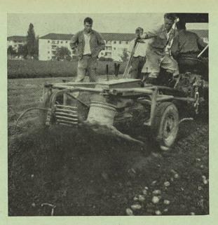
Abb. 11: Siebradgraber mit einem Hauptsiebrad und zwei ihm vorgelagerten Siebrädern.
