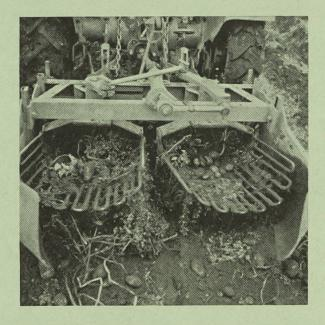
Abb. 13: Filzbildung durch Unkraut (Vogelmiere) auf dem Schüttelsieb.
