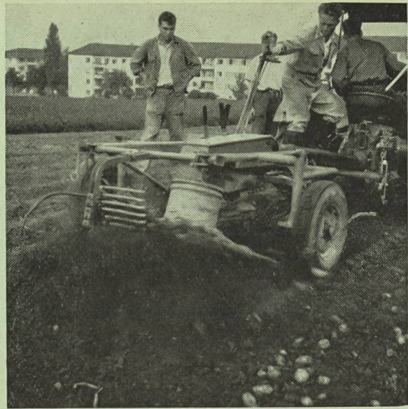
Abb. 11: Siebradgraber mit einem Hauptsiebrad und zwei ihm vorgelagerten Siebrädern.
