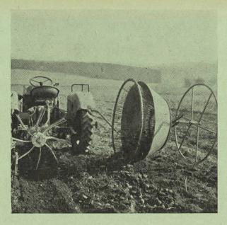
Abb. 3a: Siebtrommel mit Innenablage der Kartoffeln.
