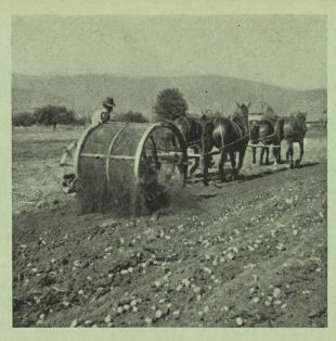
Abb. 3b: Siebtrommel mit Aussenablage der Kartoffeln
