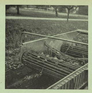
Abb. 10: Siebkettengraber mit Fallstufe und eingehängtem Kettenbund.
