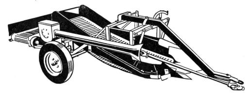
**für Zapfwellenantrieb.** Verstellbare Radspur, leicht und handlich. Ueber eine zweiteilige Rodeschar gelangt die Furche auf ein Siebband, welches durch Exzenter in Rüttelbewegung versetzt, die Kartoffeln auf eine äusserst schonende Art von Erde befreit. Durch ein Quer-Transportband erfolgt die Reihenablage nach rechts seitwärts. Gegen einen bescheidenen Mehrpreis wird ein Rübenrodegerät mitgeliefert.
