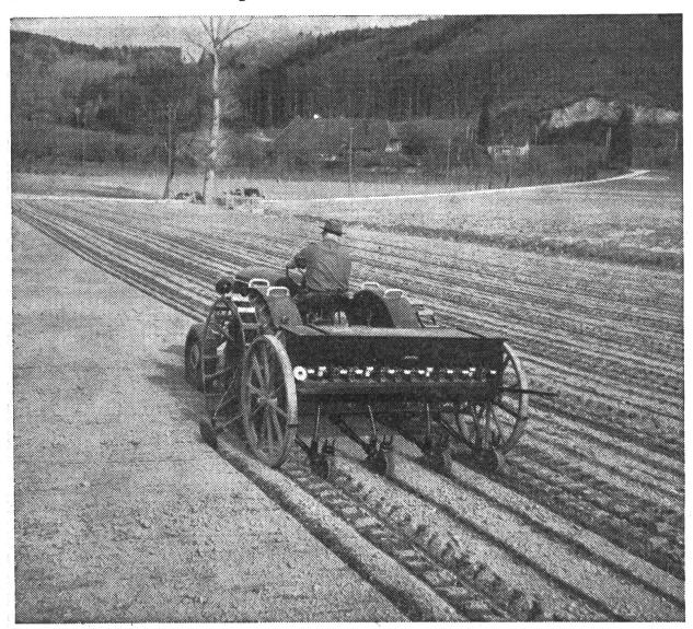
Die AEBI-Sämaschine läßt sich am modernen Vielzwecktraktor an die Dreipunkt-Hydraulik anbauen. Zum Säen arbeitet sie in der üblichen Weise mit Bodenantrieb; beim Wenden und beim Fahren auf der Straße hebt man sie mit der Hydraulik vom Boden ab. Die Sämaschine ist mit Spurmarkierern und mit Spurlockerern für den Traktor ausgerüstet. Die Ausrüstung paßt auch an früher gelieferte AEBI-Sämaschinen.
