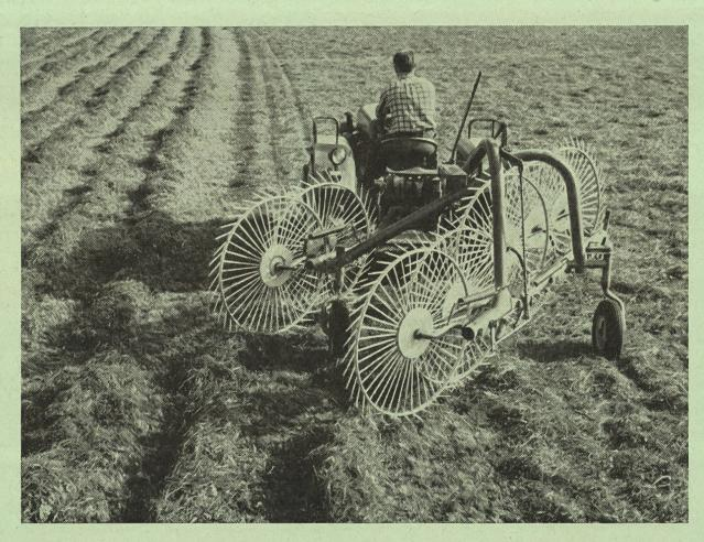
Abb. 5c: Anordnung der Sternräder in zwei Gruppen zur Herstellung von zwei Kleinschwaden (evtl. späteres Wenden derselben).
