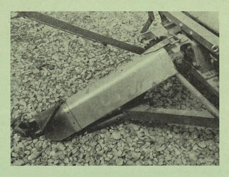
Abb. 3: Dieser Zapfwellenschutz vermag das Aufwickeln von langhalmigem Futter nicht zu verhindern. Die Zapfwelle muss daher vollständig umschlossen sein.
