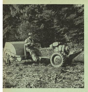
bb. 2c: Zetten in gesondertem Arbeitsgang, mit em Einachstraktor als Zugmaschine. (Das Zetten ird durch das Wendemanöver erschwert.)
