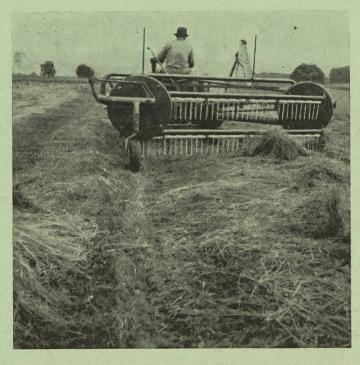
Abb. 4c: Kombinierter Schrägtrommel-Schwadenrechen für Zapfwellenantrieb mit aufklappbaren Zinkenfeldern.
