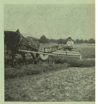
Abb. 4d: Schrägtrommelschwadenrechen mit Sitz anordnung hinter der Trommel.
