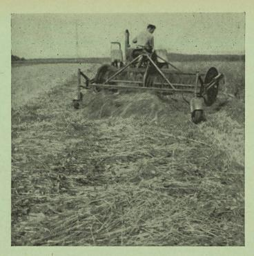
Abb. 8: Trommelschwadenrechen mit Zapfwellenantrieb beim Zetten der Mahd.
