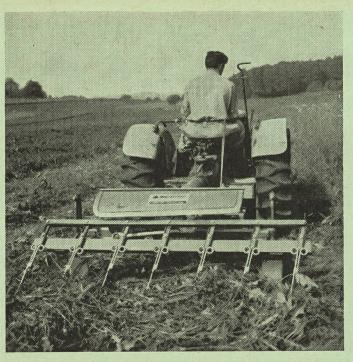
Abb. 2d: Zettmaschine mit sich hin- und herbewegenden Zinken.
