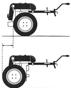
Ein weiterer Vorteil ist, dass das Gewicht, d. h. der Schwerpunkt nach Bedarf horizontal verlagert werden kann, wodurch die Maschine im Gleichgewicht gehalten werden kann, ob nun die Zusatzgeräte vorn oder hinten angeschlossen werden.
