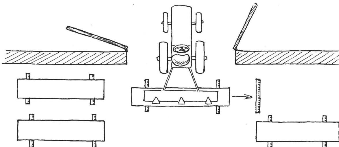
So werden auf einem Brett abgestellte Arbeitsmaschinen oder -geräte am einfachsten seitlich verstellt.
