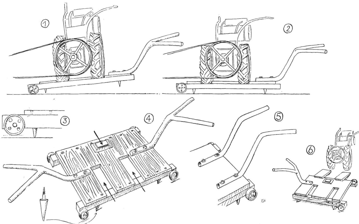
Abb. 1 und 2 zeigen, wie der Karren gleichzeitig als Riemenspannvorrichtung dienen kann.
