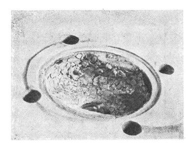
Bild 2: Starke Rückstandsbildung im Zylinderkopf eines 98-ccm-Zweitakt-Motors.
