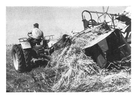
Abb. 3: Ein Traktor mit Doppelbereifung am Bindemäher, 2,10 m Schnittbreite.
