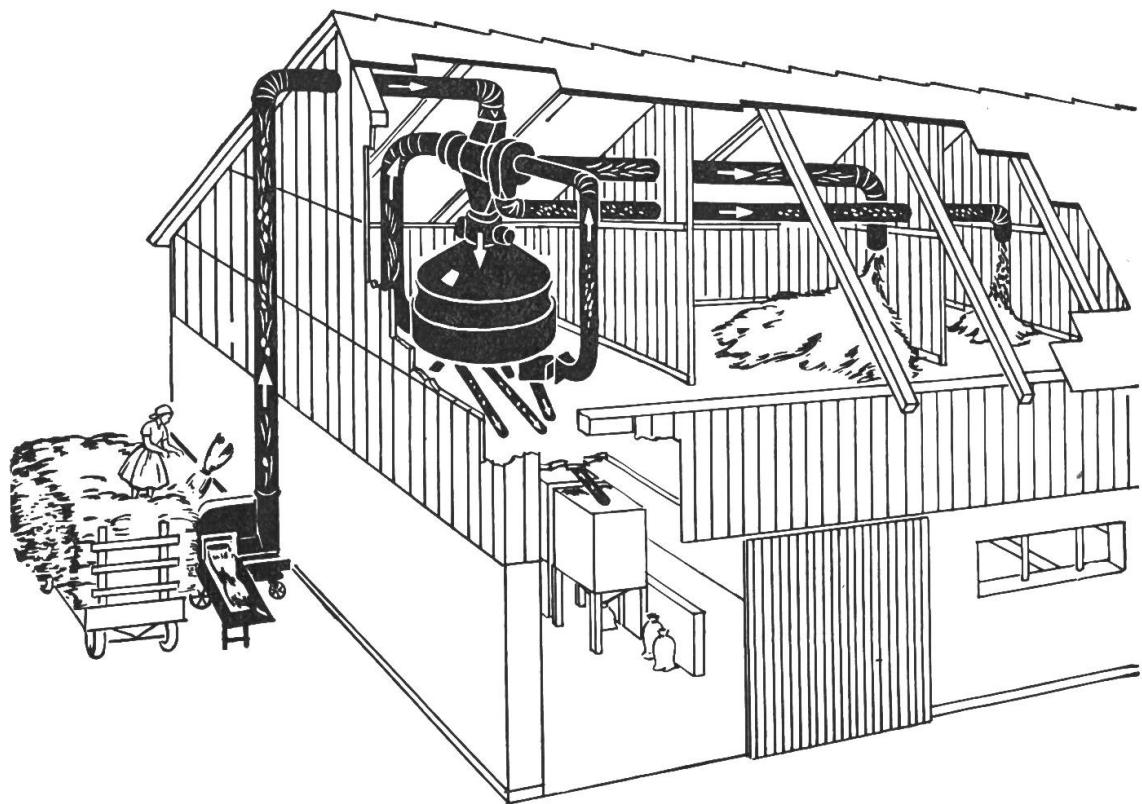
sind. Diese neue Dreschanlage wird ortsfest eingebaut und steht jederzeit zum Drusch bereit. Ferner kann die Anlage auch zum Beschicken und Entlüften des Heustockes Verwendung finden und sogar noch zur Stallentlüftung benutzt werden.
