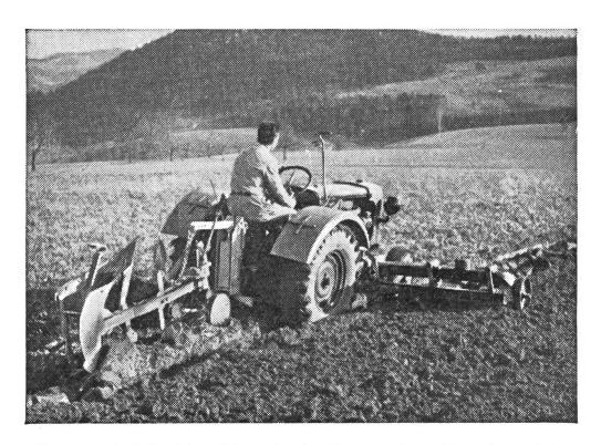
Ott-Anhaupflüge mit Stützrädern leisten in der Ebene und am Hang beste Arbeit. Sie sind wahrend der Arbeit weitgehend unabhängig von den Bewegungen des Traktors und in der Arbeitsleistung deshalb den Selbsthalterpflügen am ähnlichsten. Verlangen Sie unverbindliche Offerten für Anbaupflüge und Anbaukultivatoren.
