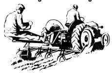
Hochwertige, hangsichere Hackmaschine durch Feinsteuerung der einzelgefederten Hackwerkzeuge in der Ebene und am Hang. Eignet sich ausgezeichnet für alle Hackkulturen. Arbeitet mit oder ohne Steuermann.
