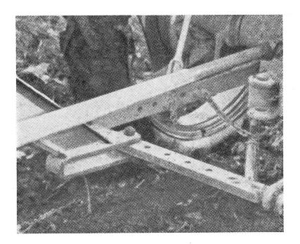
Seiten leicht schwenkbar sein. Die Verbindung des Zwischenstückes mit der Ackerschiene erfolgt durch einen Steckbolzen, mit dem Anhängemaul des Binders durch einen Schraubenbolzen, dessen Mutter mit Splint gesichert wird.
