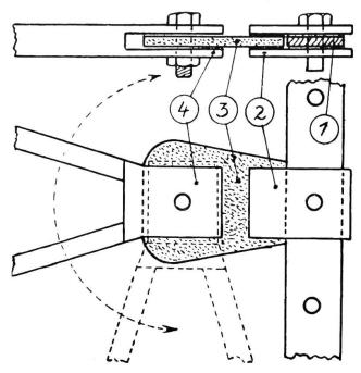
Das Anhängezwischenstück ermöglicht unbeschränkte Seitenschwenkbarkeit des Geräteanhängemaules. Begrenzt wird der Einschlag erst dadurch, dass das innere Hinterrad des Traktors an das Gerät oder an dessen Anhängedeichsel oder -gabel stösst.
