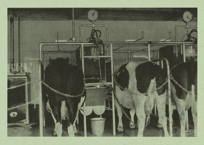
Melkstand mit Milchabsauganlage auf einem Gutsbetrieb in Deutschland
