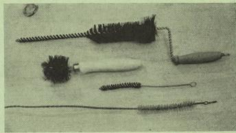
Bei der wöchentlichen Generalreinigung ist das Melkzeug in seine Bestandteile zu zerlegen und mit den mitgelieferten Spezialbürsten gründlich zu reinigen.
