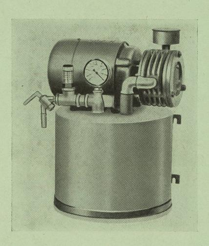
Elektromotor, Vakuumpumpe und Ausgleichsbehälter sind zu einer Einheit zusammengebaut.
