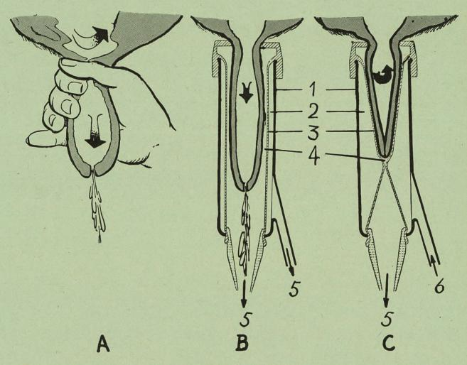
Unterschiedliche Behandlung des Euters durch das Hand- und das Maschinenmelken. A = Handmelken, B = Saugtakt, C = Entlastungstakt.
