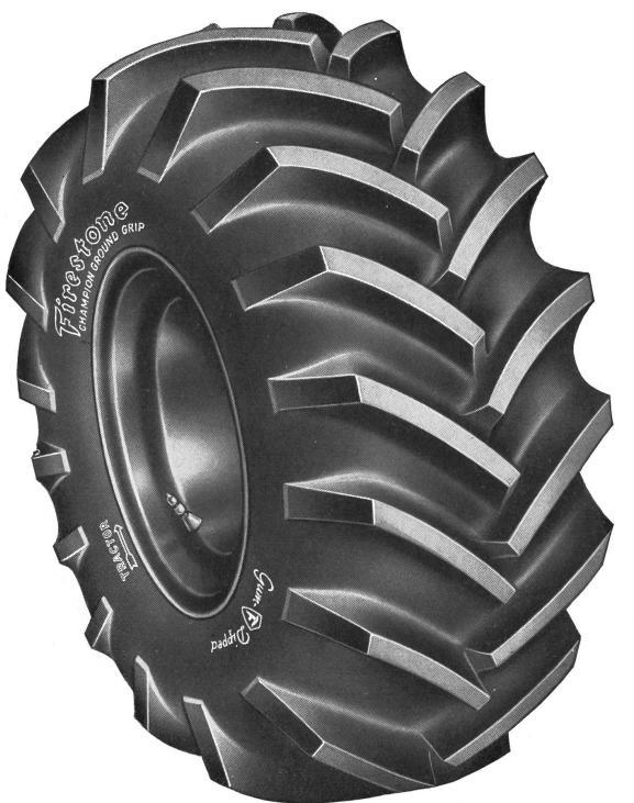
Die Profilstollen sind konisch. Sie fassen das Erdrei tiefer in dasselbe d Zugkraft.
