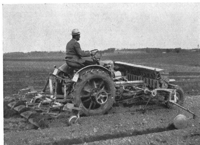
Eicher-Kombi-Geräteträger beim Maissäen und -zuhäufeln in einem Arbeitsgang.
