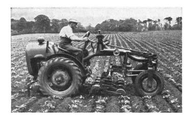
David-Brown-Geräteträger 2 D, mit luftgekühltem 2-Zylinder-Heck-Dieselmotor, beim Querhacken von Kohlrüben.
