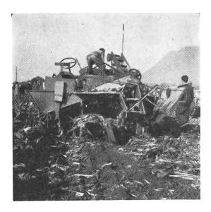
Abb. 10b 1-reihige Vollerntemaschine «Stoll». Blatt und Rübenerntevorrichtung sind hier in derselben Maschine vereinigt. Die Rüben werden auf den Unimog befördert, die Blätter an Längsschwaden abgelegt. Man beachte das Schleuderrad, durch welches der aus dem Boden ragende Teil der Rüben sauber nachgeputzt wird.
