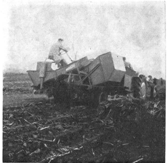
Abb. 7a und 7b: Vorratsgraber «Schmotzer» und «Stoll» mit Sammelbehältern (Bunkern). Rüben und Blatt werden in gleichem Arbeitsgang an Querschwaden abgelegt.
