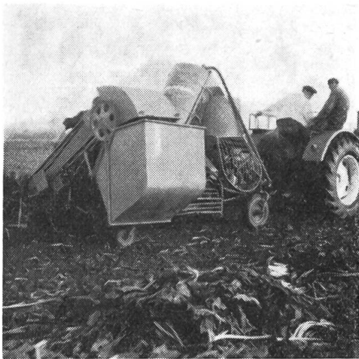
Abb. 7a und 7b: Vorratsgraber «Schmotzer» und «Stoll» mit Sammelbehältern (Bunkern). Rüben und Blatt werden in gleichem Arbeitsgang an Querschwaden abgelegt.
