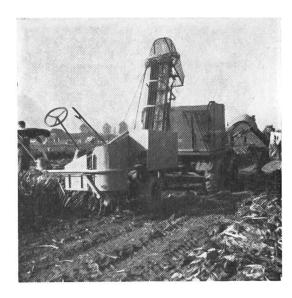
Abb. 10a 1-reihige Vollerntemaschine «Kleine» mit Blatterntevorrichtung an der Front des Unimog. Die Rüben werden auf die Ladebrücke des Unimog gefördert und am Feldende durch Kippen der Brücke entleert. Das an Längsschwaden abgelegte Blatt wird mit der Lademaschine geladen. Grundsätzlich lässt es sich aber auch auf einen traktorgezogenen Transportwagen fördern.
