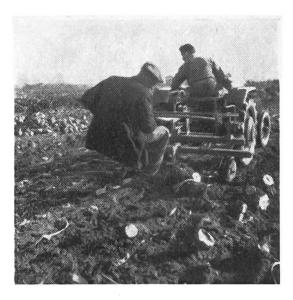
Abb. 4 Gewöhnlicher Rodepflug am Traktor-Anbauvielfachgerät
