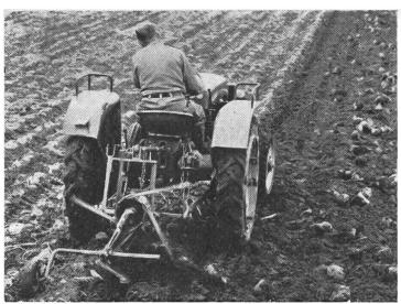
Abb. 5 Einfacher Anbaugraber (Kartoffelgraber, ausgerüstet mit Rodezinken).
