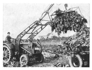
Abb. 2 Laden des Rübenblattes mit Frontlader vom Querschwaden weg.
