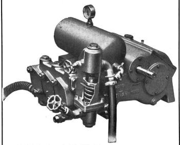
Betriebsdruck 50-60 Atm. Förderleistung 75-90 I/min.
