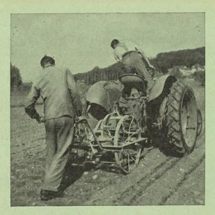
Abb. 2: Dänische Querhackmaschine
