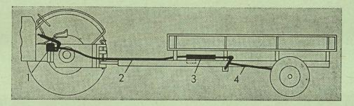
1 = Steueraggregat mit Handbremshebel. Dieser Teil kann auch am Anhänger montiert werden. 2 = Schlauchverbindung des hydraulischen Teils zum Anhänger. 3 = Federspeicher am Anhänger. 4 = mechanische Verbindung zur Bremsvorrichtung.
