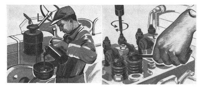
**Luftfilterpflege.** Im Oelbad-Luftfilter ist der richtige Oelstand für dessen Wirksamkeit entscheidend. Gründliche Staubabscheidung vermindert den Verschleiss und verlängert damit die Lebensdauer des Motors. Dickflüssiges oder schlammiges Oel muss rechtzeitig gewechselt werden.
