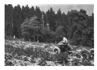
Der Unterbau des gleichen Fahrzeuges im Einsatz als Geräteträger beim Kartoffelhäufeln am Hang. . . . .
