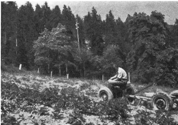
Der Unterbau des gleichen Fahrzeuges im Einsatz als Geräteträger beim Kartoffelhäufeln am Hang. ....
