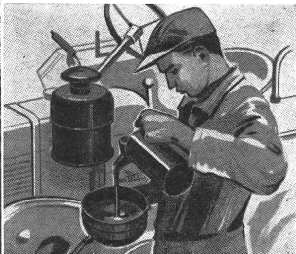
Abb. 3: Luftfilterpflege. Im Oelbad-Luftfilter ist der richtige Oelstand für dessen Wirk-samkeit entscheidend. Gründliche Staub-abscheidung vermindert den Verschleiss und verlängert damit die Lebensdauer des Motors. Dickflüssiges oder schlam-miges Oel soll rechtzeitig gewechselt werden.
