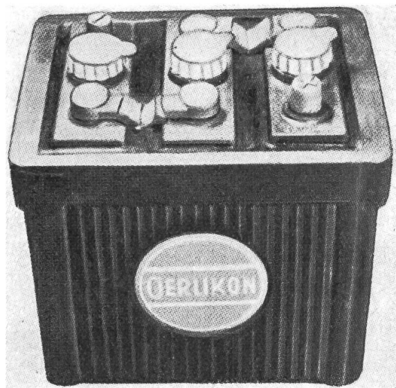
Trotz Kurzschluss und durchgeschmolzenen Polverbindungen keine Knallgas-Explosion.
