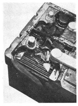
Durch Knallgas-Explosion zerstörte Batterie
