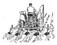
hig ausgerüstet, arbeitet es doppelt so breit und mit nahezu doppelter Geschwindigkeit wie ein Pferdezug-Vielfachgerät und hackt in der Stunde 90 bis 100 a. Ein Landwirt hat uns berichtet, er habe im letzten Sommer mit dem Traktor-Vielfachgerät seine 17 Jucharten Kartoffeln am gleichen Tag gehäufelt.
