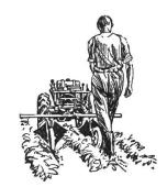
Aehnliche Leistungen erzielt der Einachstraktor mit Anbau-Vielfachgerät und hat dazu noch den Vorteil, dass eine einzige Person das Gerät und die Zugmaschine bedienen kann. Es braucht hier praktisch kein Vorgewende, und es ist kein schädlicher Bodendruck zu befürchten.
