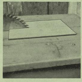
Abb. 2a Fräsentisch mit abgedecktem Frässchlitz
