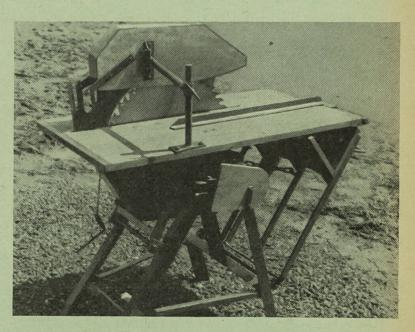
Abb. 6b: Wippfräse, eingerichtet für Längsschnitte.
