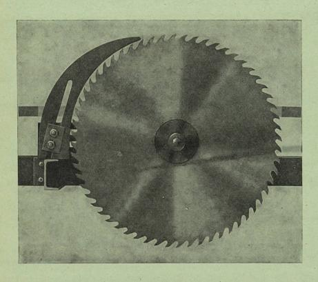
Abb. 5a Verstellbarer Spaltkeil.
