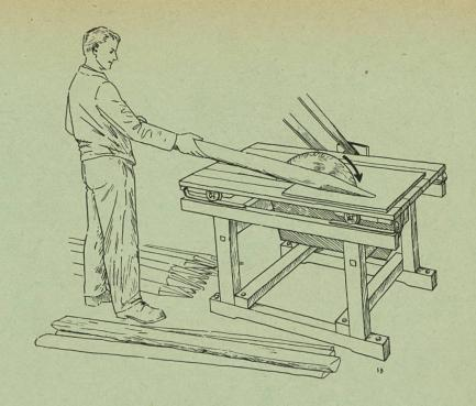
Die Tischfräse ist keine Holzbearbeitungsmaschine. Wer sie dazu verwenden will, muss ihr einen bestimmten Standort zuweisen und sie mit den erforderlichen Schutzvorrichtungen ausrüsten. Als Standort wähle man einen vor Regen und Wind geschützten Platz in der Nähe einer Wand, so dass dort die für Holzbearbeitung unentbehrliche Spezial-Schutzhaube leicht angebracht werden kann.
