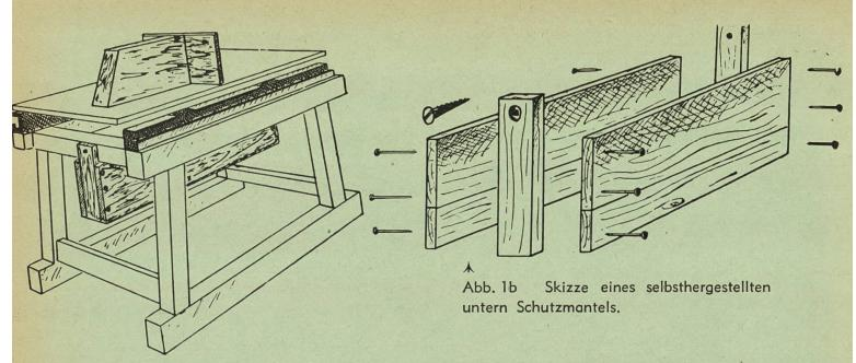
Abb. 1a Gewöhnliche Tischfräse mit unterem und oberem Schutzmantel. Der untere Schutzmantel schützt vor Hand-, Arm- und Fussverletzungen beim Entfernen des Sägemehlhaufens unter dem Fräsentisch.
