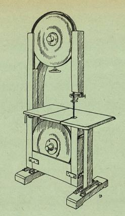
Die Unfälle an Bandsägen sind meistens auf schlechte Schnittfähigkeit des Sägenblattes, das Abspringen des Blattes von den Führungsscheiben und auf fehlerhafte Manipulationen beim Verarbeiten von knorrigem Holz zurückzuführen.
