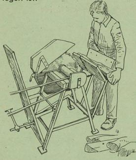
Abb. 6a Wippfräse beim Verarbeiten von Brennholz
