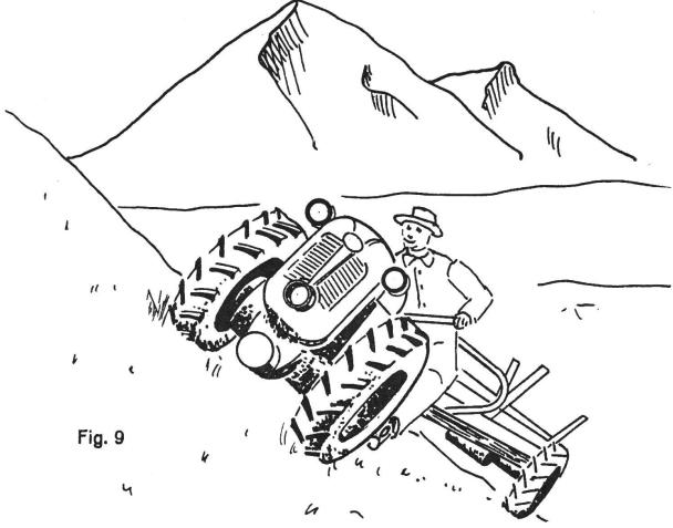
Fig. 9: Wird am Hang seitlich gefahren, dann schätzt man es sehr, wenn die Maschine zur Vermeidung der Kippgefahr tief gestellt werden kann (verstellbare Triebräder). Ebenso wichtig ist es, dass der Einachser mit einem leicht wegnehmbaren und aufdrehbaren Mähausleger versehen ist.
