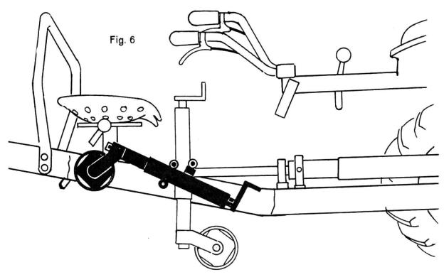
Fig. 6: Die Stützrolle des Anhängers ist bei vielen Typen zu wenig versenkbar. Fig. 6 zeigt die gute Lösung beim Triebachsanhänger RAPID.
