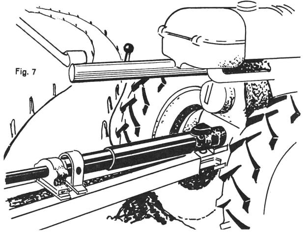
Fig. 7: Ist die Kardanwelle über dem Chassis des Anhängers montiert, so können Beschädigungen beim Ueberfahren von Bodenwellen vermieden verwenden; die Führung der Kardanwelle unter dem Chassis bringt nachteilige Folgen mit sich.
