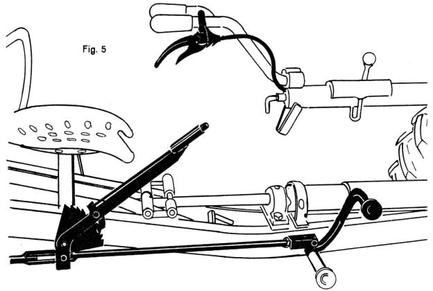
Fig. 5: Sehr günstige Anordnung des Schalthebels am Einachstraktotr Rapid Typ S; mit einem einzigen Hebelgriff können alle 4 Räder vom Vorwärts- auf den Rückwärtsgang geschaltet werden, was beim Fahren in schwierigem Gelände äusserst wichtig ist.
